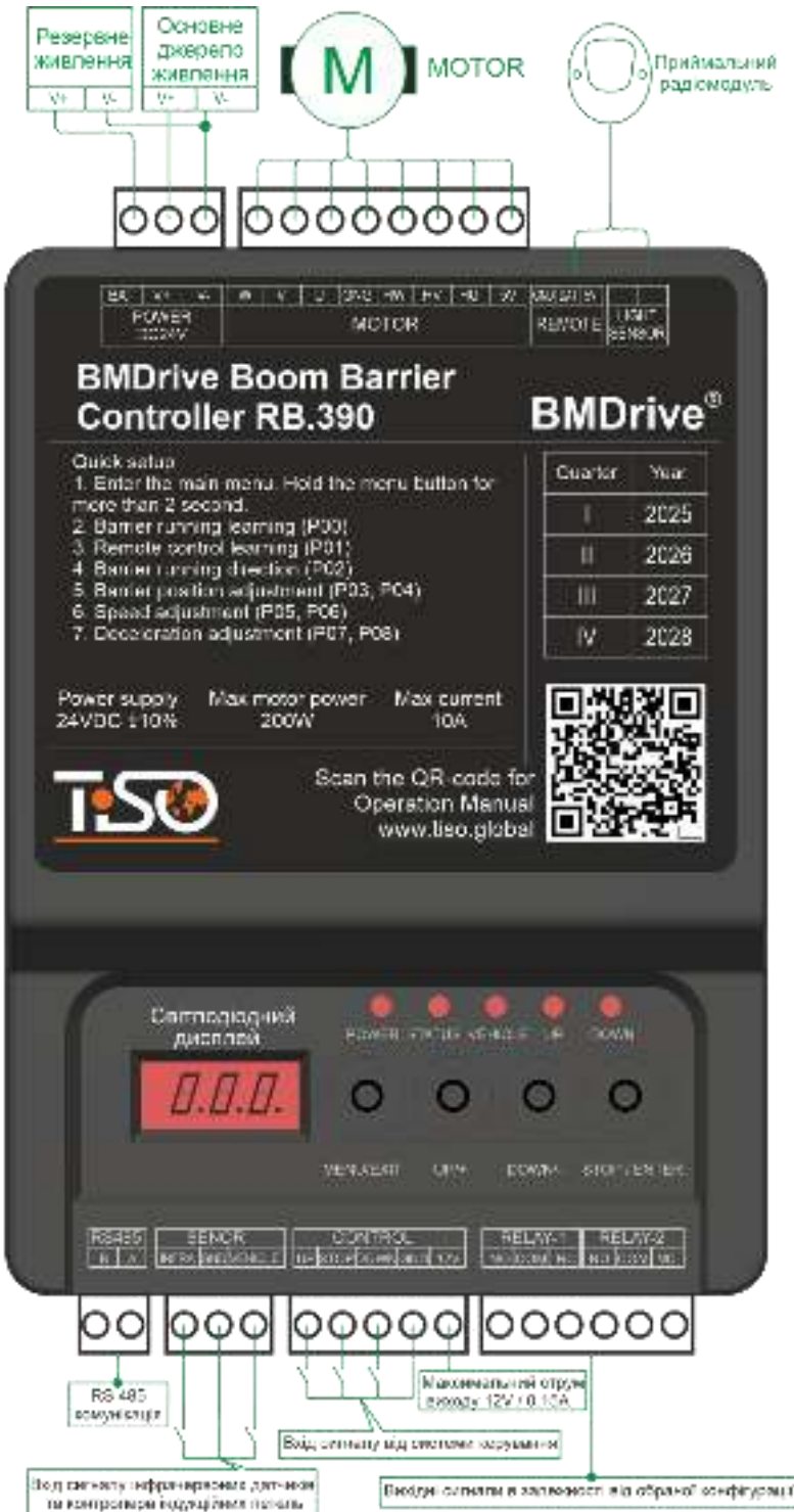
Рис.17 - Призначення роз'ємів контролера RB390
