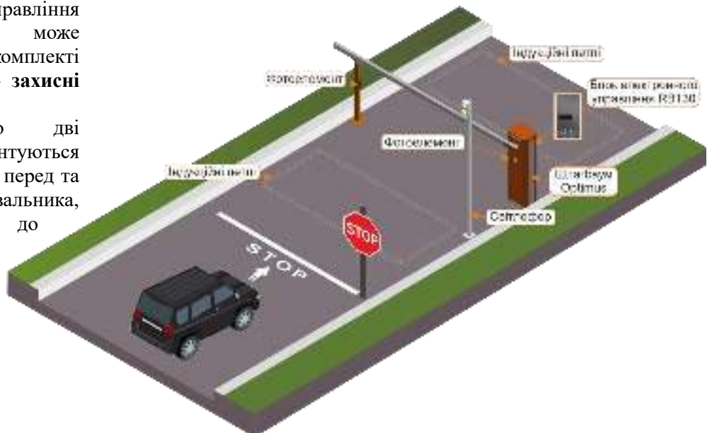
Рис.10 – Індукційні петлі в проектному положенні
