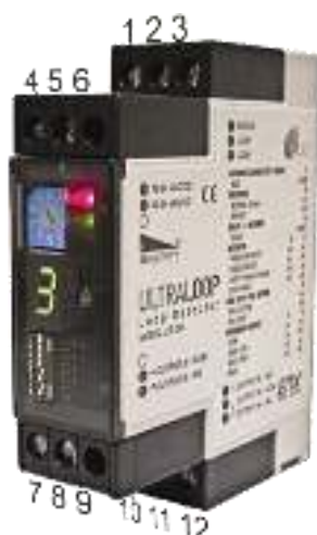
Рис.13 - Позначення роз'ємів контролера індукційних петель
